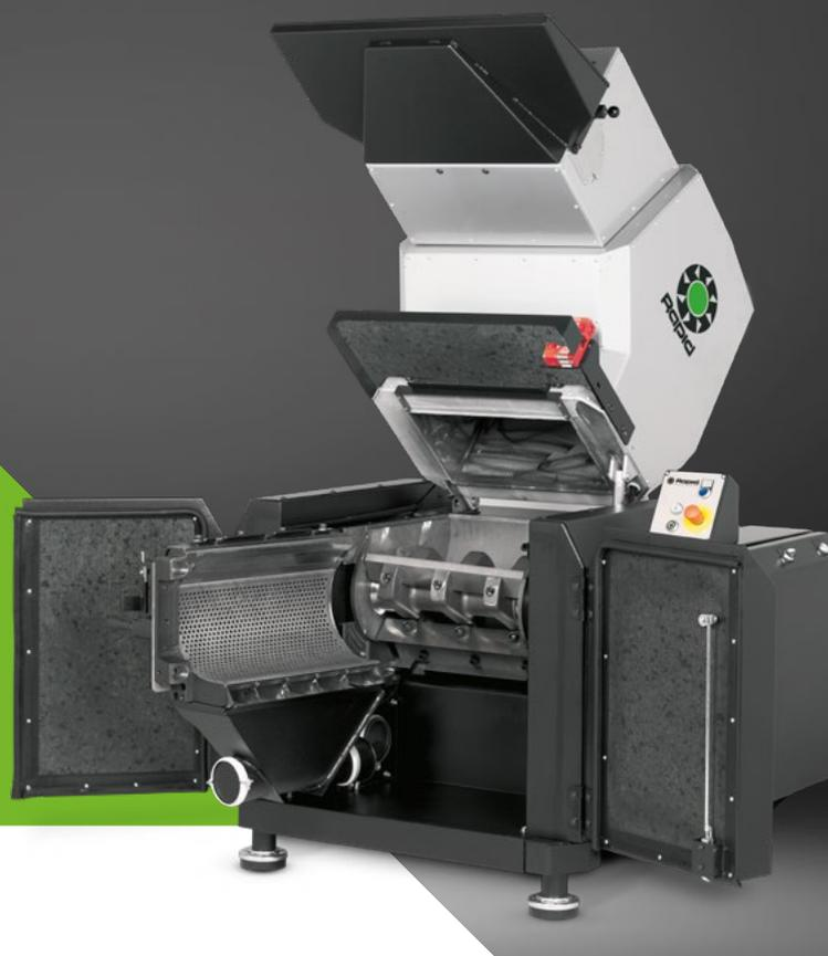
Les modèles de la série Rapid 400 peuvent tous être utilisés comme broyeurs centraux ou comme broyeurs « en ligne » dans tous les types d'applications. Les applications typiques sont le broyage de pièces volumineuses, de tous types de produits mis au rebut, de tuyaux plus petits, de profilés, etc. Quatre largeurs avec une capacité allant jusqu'à 900 kg/h.
