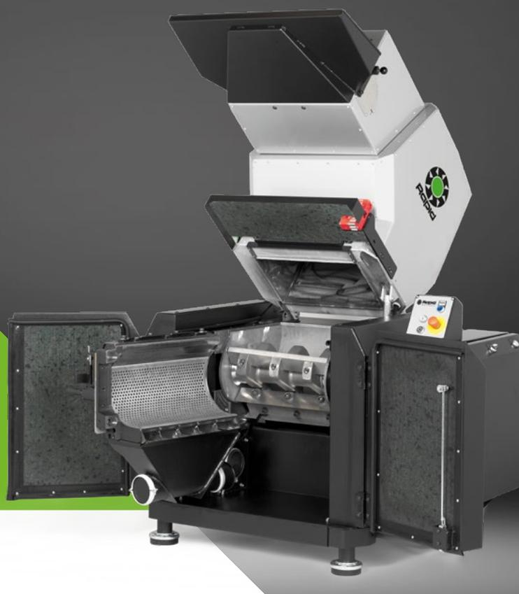
Les modèles Rapid de la série 300 peuvent tous être utilisés comme broyeurs centraux ou comme broyeurs « en ligne » dans toutes les applications. Application de divers rebuts injectés, soufflés, extrudés. Capacité max de 500 kg/h suivant applications.
