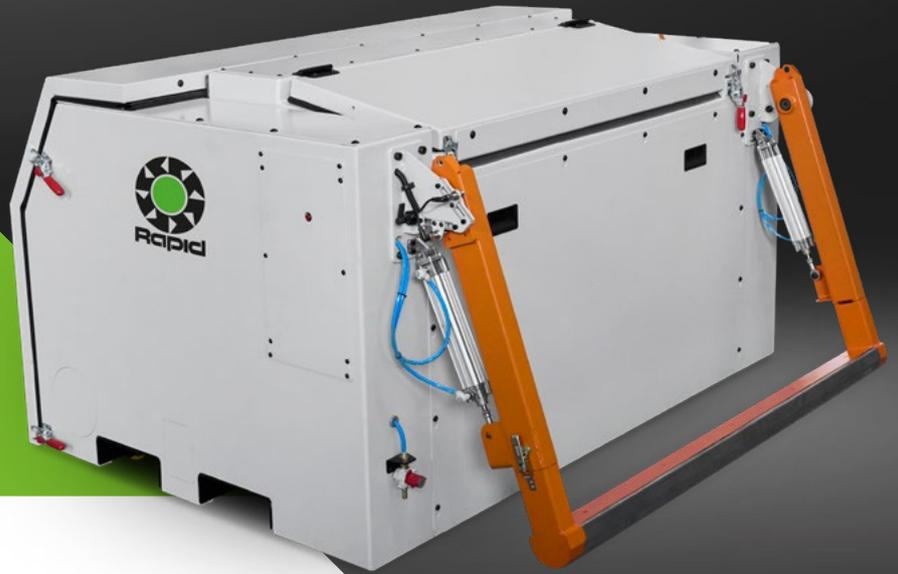
Le Rapid GT1100 est optimisé pour le broyage en ligne des squelettes de thermoformage.
