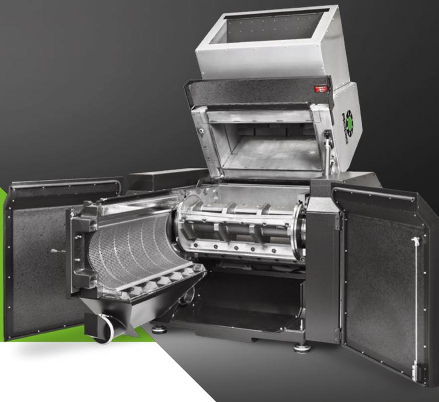
Les modèles de la série Rapid 500 peuvent être utilisés pour tous les types de broyage, en ligne ou en tant que broyeurs centraux pour des produits plus volumineux ou lorsqu'une capacité plus élevée est requise. Les applications typiques sont le broyage de grandes quantités de pièces rebutées, de rebuts plus volumineux, de profilés, de feuilles ou plaques de tuyaux, etc. La série Rapid 500 est disponible avec des largeurs de broyeur de 600, 900 et 1200 mm. Capacité jusqu'à 1,2 tonnes/h.
