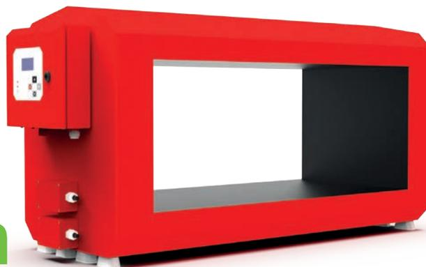
Nos détecteurs de métaux sont sensibles et détectent tous les types de matériaux ferreux et non ferreux. Le plus courant est d'avoir le détecteur le métal intégré sur un convoyeur à bande.
