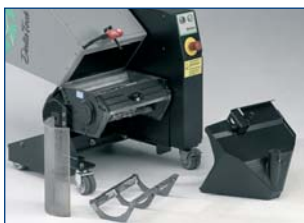
Leichte Wartung/Reinigung – sofortiger Zugang zu Rotor und Mahlkammer.
